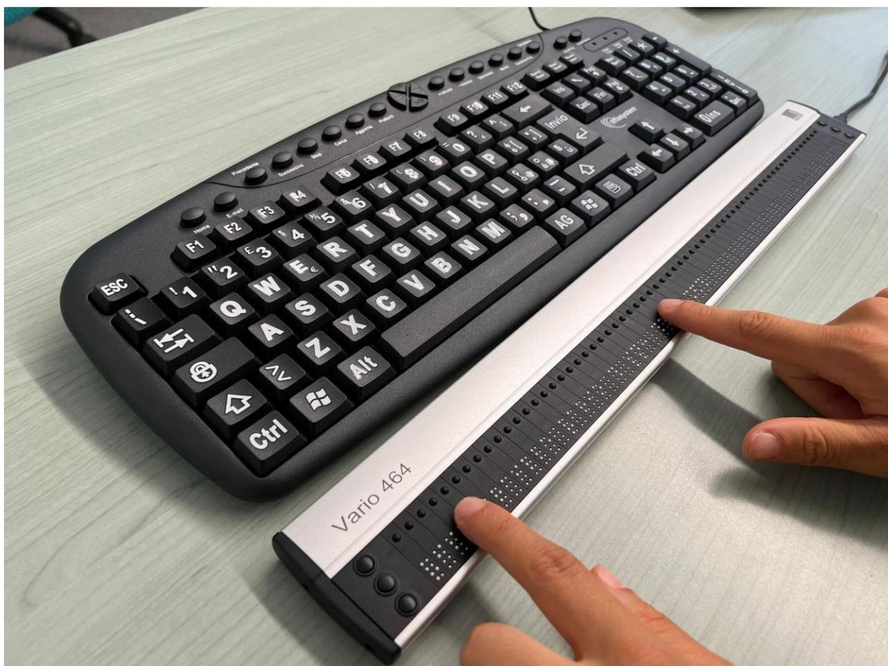
Vario 464 è un display Braille a 64 caratteri di alta qualità, una soluzione compatta e leggera facile e comoda da utilizzare. Si collega automaticamente al proprio pc senza la necessità di installare driver. Dispone di tasti funzione e cursori integrati, porta USB per presa tipo C ed è compatibile con i principali screen reader.
